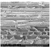
Gambar.11. Hasil Pengujian Morfologi (a) Bambu petung P=800 Watt dan t=3 menit dengan perbesaran 800x (b) Bambu ori P=800 Watt dan t=2 menit dengan perbesaran 800x
