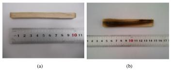
Gambar. 1. Bambu petung (a) sebelum diberi perlakuan (b) radiasi pemanasan gelombang mikro selama 1 menit.
