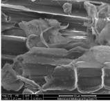
Gambar.10. Hasil Pengujian Morfologi (a) Bambu petung dengan perbesaran 800x (b) Bambu petung dengan perbesaran 2000x
