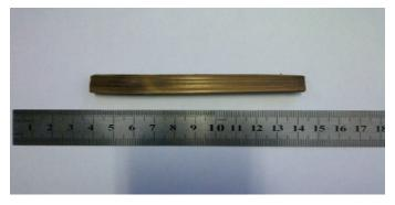
Gambar. 2. Bambu petung dengan radiasi gelombang mikro daya 800 watt selama 3 menit.
