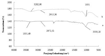
Gambar. 7. Sperktrum Infra Merah (a) Bambu Petung Hijau (b) Bambu Petung 800 watt 3 menit.
